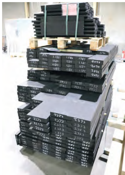
Een gereed pakket. Op verzoek van de aannemer zijn de gecoate balkjes per lengte genummerd op de kopse kanten.
