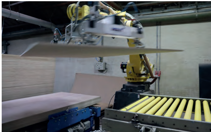
Hout+ reviseerde een oude laklijn en voegde er twee robots aan toe voor in- en uitvoer.
