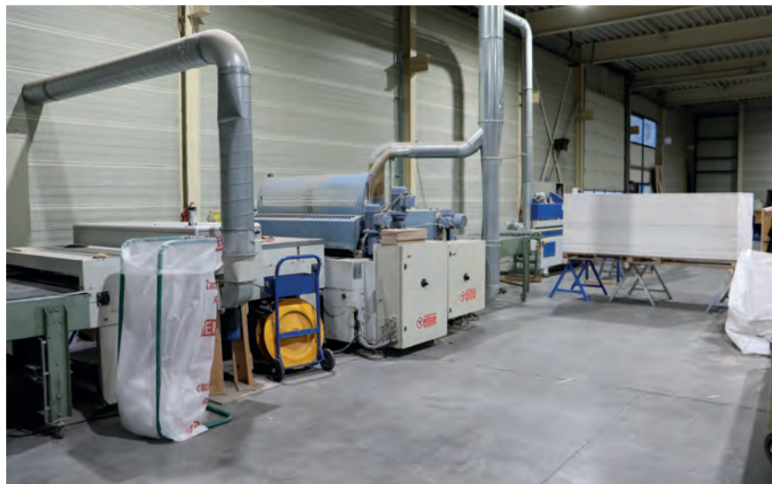
De lakstraat heeft meerdere UV-lampen. Zo kunnen wel vijf lagen in één werkgang worden aangebracht op een houten plaat.
