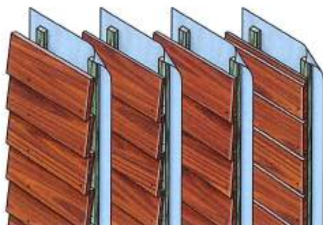
Tekening 1 Horizontale gevelbekleding: v.l.n.r. potdekselwerk, Bevel siding, Zweeds rabat en halfhoutse rabat.
