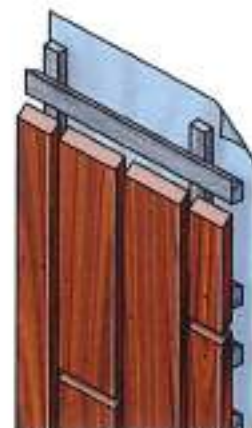
Tekening 4 Verticale open gevelbekleding op dubbel regelwerk.
